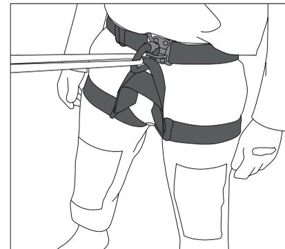
Auto-évacuation d'urgence: le ceinturon et la sangle, rassemblés par un mousqueton, deviennent un baudrier permettant une évacuation d'urgence
